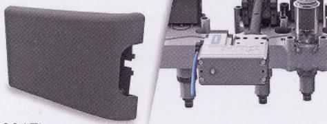
Besonders flexibel seien die Flexflow-Elemente durch die Möglichkeit, Drücke und Fließgeschwindigkeiten an jedem Anspritzpunkt individuell zu steuern. Als ersten Schritt hin zur Integration in die Spritzgießmaschinensteuerung nennt der Anbieter die seit kurzem verfügbare Option, die Parameter über den Touchscreen der Spritzgießmaschine einzustellen.
