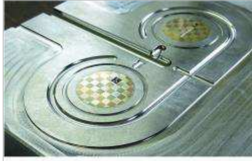
Kavität für das Give-away mit gefrästem Hologramm – (Bild: Leonhardt e. K.).
