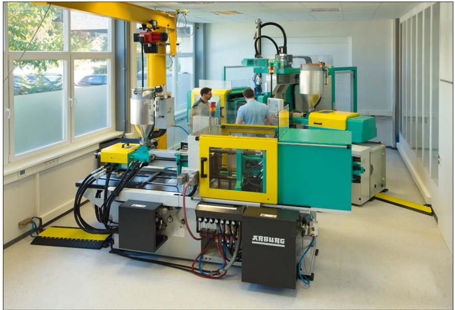
Im Spritzgiesstechnik prüft Leonhardt alle im Haus hergestellten Werkzeuge auf «Herz und Nieren», es steht auch für Kleinserien aus Kundenmaterial und zur Fertigung von Sonderbauteilen zur Verfügung.
